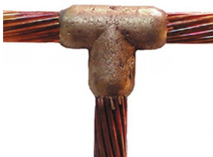
Cotah hasil pencetakan peralatan penyambung sistim CADWELD
